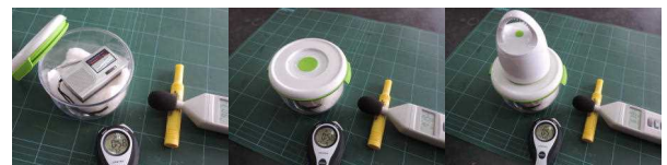
図2 デジタル騒音計による音量測定
